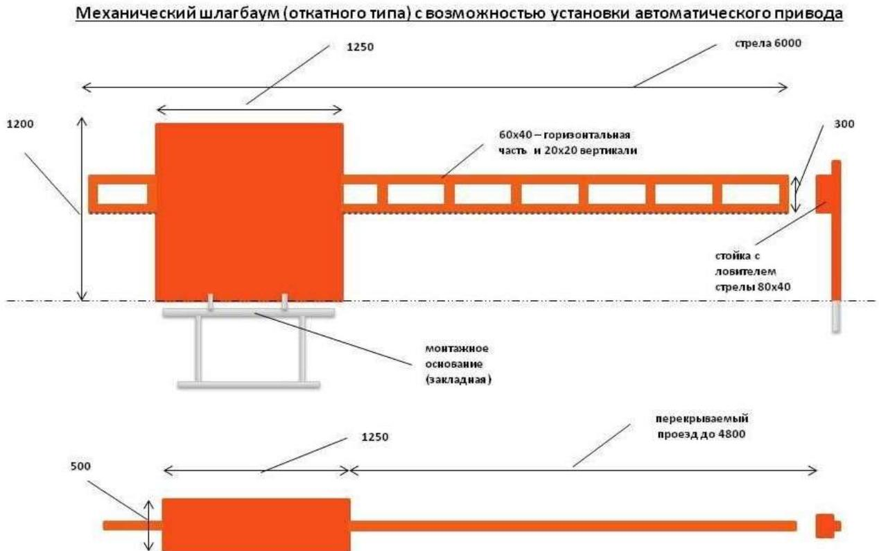
Шлагбаумы крепятся болтами на металлическую закладную вмонтированную в бетонное основание. На стойке шлагбаумов находится электромеханический привод, а также блок электронного управления. Привод, перемещающий стрелу, состоит из электродвигателя, редуктора. Шлагбаумы снабжены регулируемыми элементами безопасности, а также устройством фиксации стрелы в любом положении и ручной расцепитель для работы в случае отсутствия электроэнергии.
